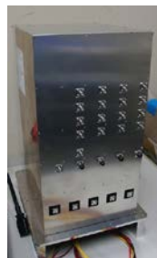
デジタルビーム形成回路＋アレイアンテナ試作 (20-30GHz)
