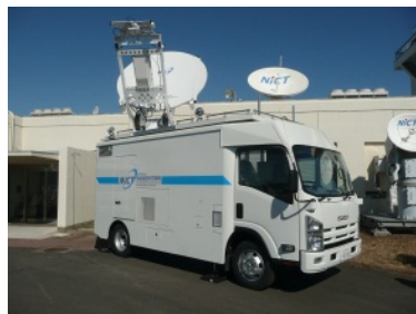
大型車載地球局 →被災地でハブとなりうる地球局
