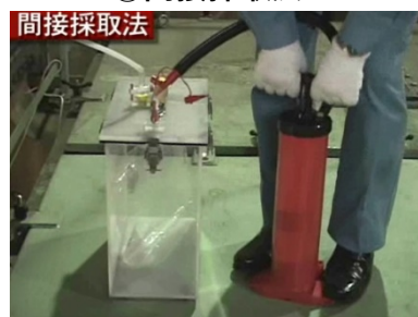
写真3 排出口法試料採取
